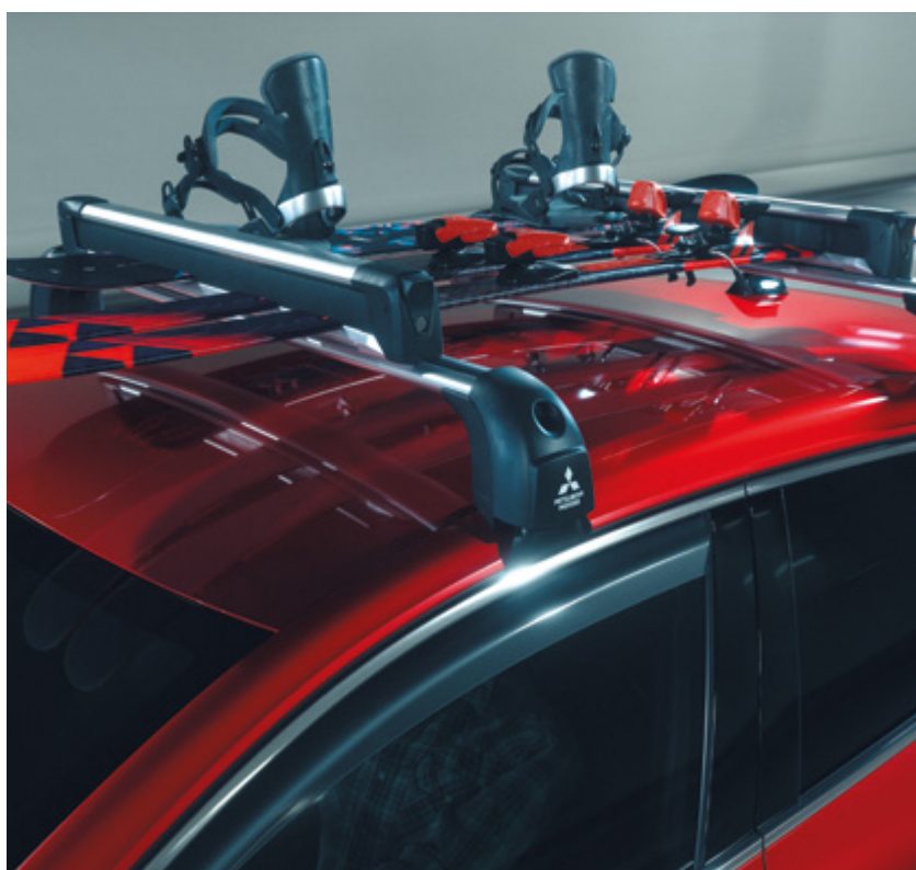
▲ Belki bagażnika dachowego Profil typu Wingbar.
